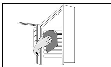
Канал для стока талой воды внутри холодильника следует периодически чистить. В случае засорения канала следует прочистить куском гибкой прочной лески.
